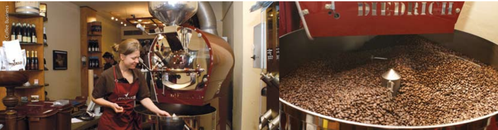
(Bild links) Während die Bohnen abkühlen, sortiert Katharina Gloft immer wieder per Hand Fehlbohnen aus. (Bild rechts) Der mexikanische Arabica aus der L'Armetetic-Kooperative zeichnet sich durch ein sehr gleichmäßiges Bohnenbild aus.
